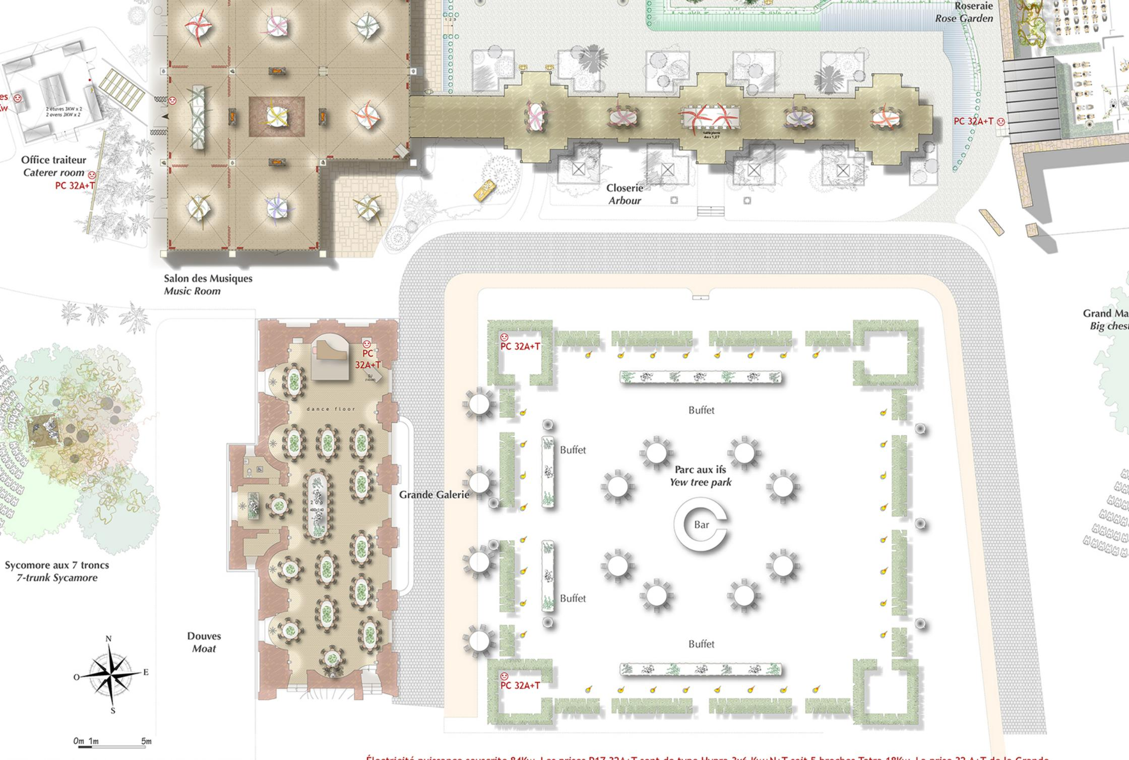
Électricité puissance souscrite 84Kw. Les prises P17 32A+T sont de type Hypra 3x6 Kw+N+T soit 5 broches Tetra 18Kw. La prise 32 A+T de la Grande Galerie et les 2 prises des ifs sont sur un seul réseau déjà sollicité par la sono de 10Kw. La sono en fonction, il ne reste que 8Kw à répartir sur les 3 prises 32A+T. Les prises du parking office Salon et de la Roseraie ainsi que les étuves sont sur des réseaux séparés qui chacun tiennent 18Kw.
